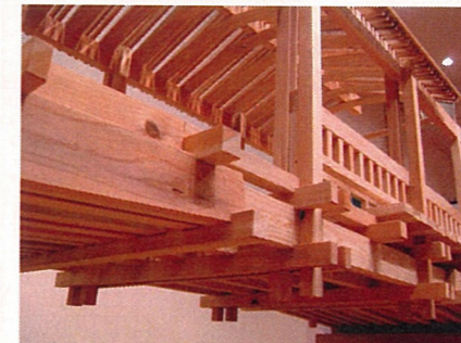
堀川運河シンボル緑地に架ける「木橋」1/5模型を地元大工棟梁・熊田原氏が自主製作し技術的な検討提案がされた。
